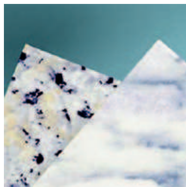
Steindekore auf Basis Pulverbeschichtung Stone-look powder coating
