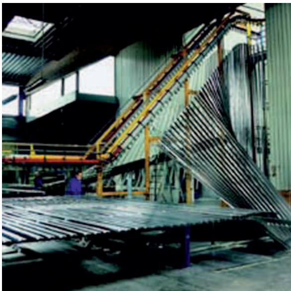
Aufstaffelung von Profilen für die Vertikalbeschichtung Stacking of profiles for vertical coating
