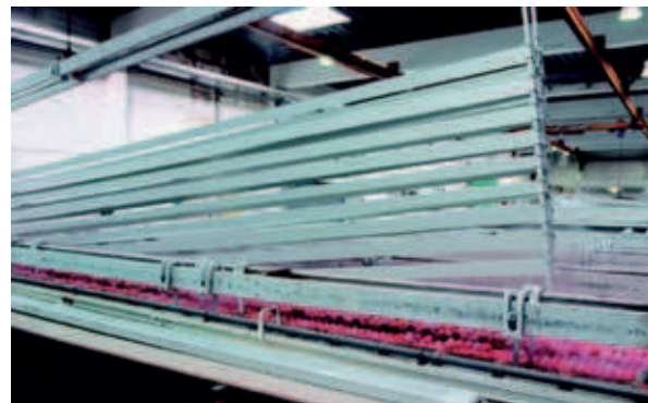
Verdichten (Schließen) der Eloxaloberfläche Sealing (closing) the anodised surface
