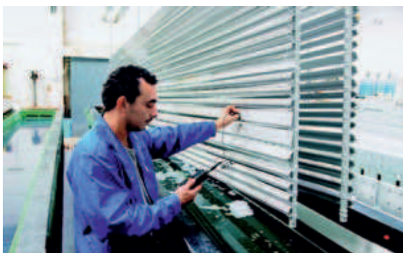
Schichtdicken-Prüfung an eloxierten Profilen Checking the layer thicknesses on anodised profiles
