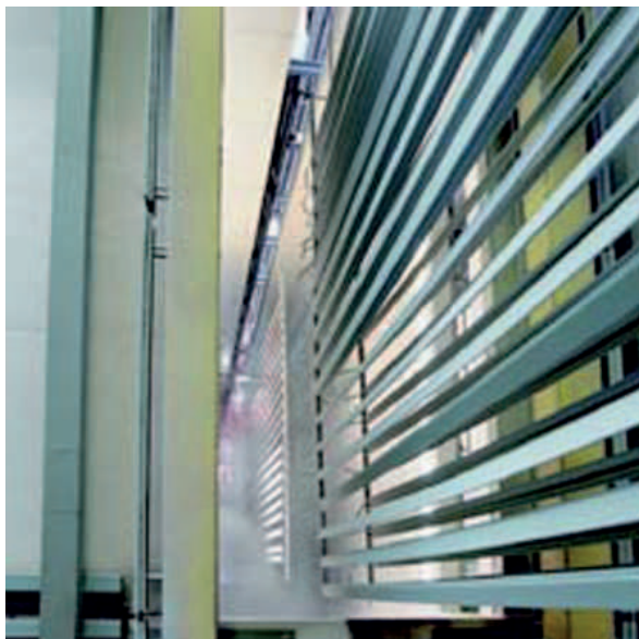
Vorbehandelte Profile auf dem Weg zur horizontalen Beschichtung Pre-treated profiles ready for horizontal coating
