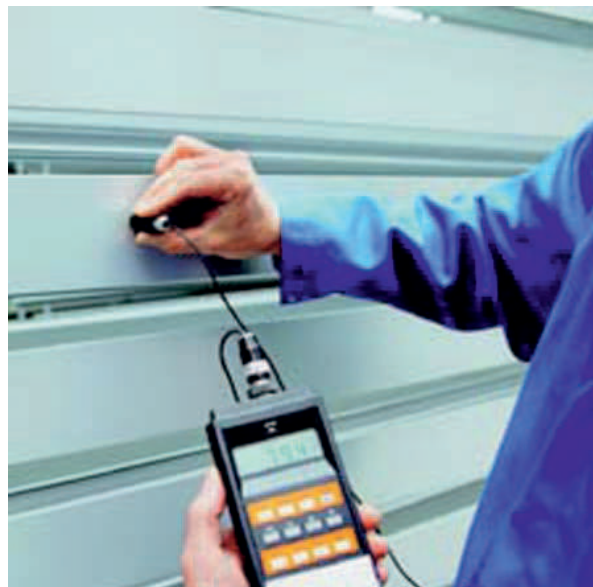
Prüfung der Schichtdicke auf veredelten Profilen Checking the coating thickness on finished profiles
